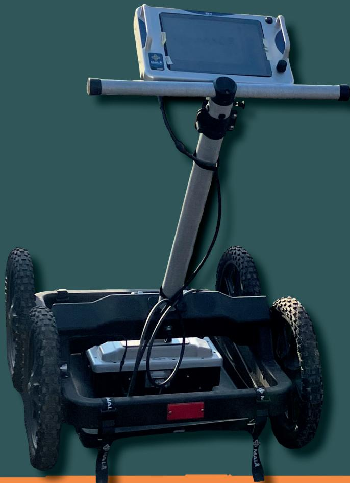
El georadar cuenta con antenas que ingresan un pulso electromagnético al subsuelo –una lo emite y otra lo recibe-. Con esa información se genera lo que se llama un radargrama, que puede compararse con una tomografía del subsuelo. En otras palabras, el georadar detecta cambios en los materiales del subsuelo.
